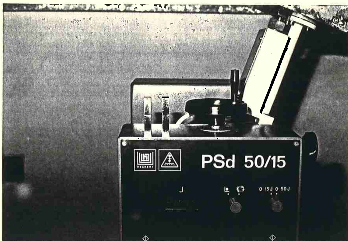
FIG.1 Aspectos da máquina de ensaio Charpy. Notar o botão de operação ao lado do display.
